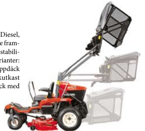
GZD21HD. Treblads Glide-Cut. Klippbredd 1219 mm.
