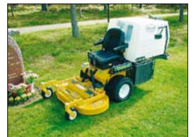
Klipparen till vänster tar alla Walker-aggregat med sidoutkast upp till 56" men kan också användas med 42" Mulcher-aggregat. Klipparen har en 18 hk B&S Vanguard-motor samt elektrisk BTO-clutch och transmission av typen Hydro Gear.
